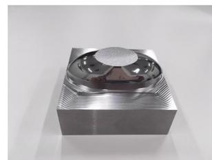
平面だけでなく、三次元(3D)曲面でも光の乱反射が出ないレベルでナノ加工が可能。
